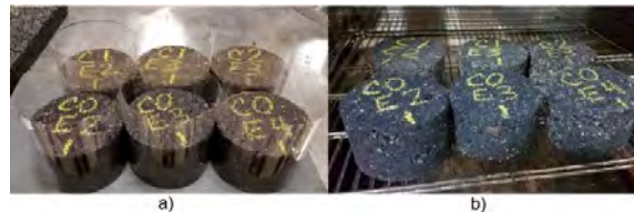
Figura 2. Curado de las probetas cilíndricas. a) Con cubierta, b) en el horno
