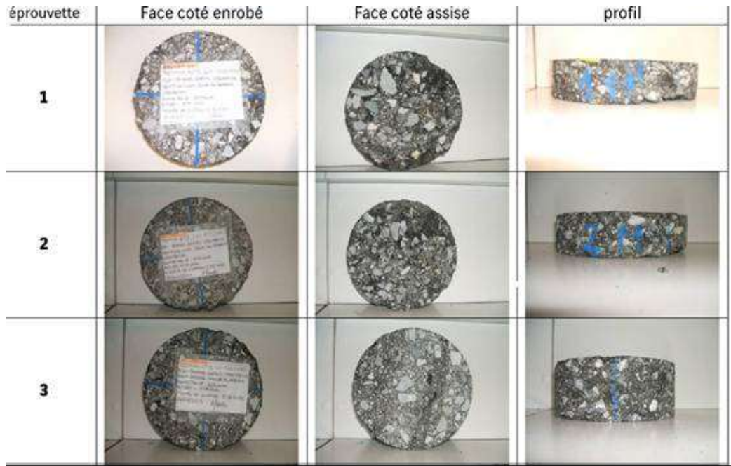
Foto 5: Ejemplo del aspecto de los testigos previa preparación para el ensayo.
