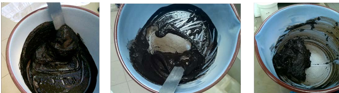
Figura 1. Evolución típica del ensayo de índice de rotura. Instantes iniciales, mitad de ensayo y finalización. Para más detalle, ver punto 9 de este documento.
